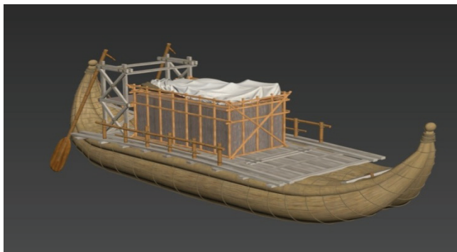
Рисунок 3 - Рулевое управление камышовой лодки «Туран»
