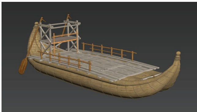
Рисунок 2 - Надстройка камышовой лодки «Туран»
